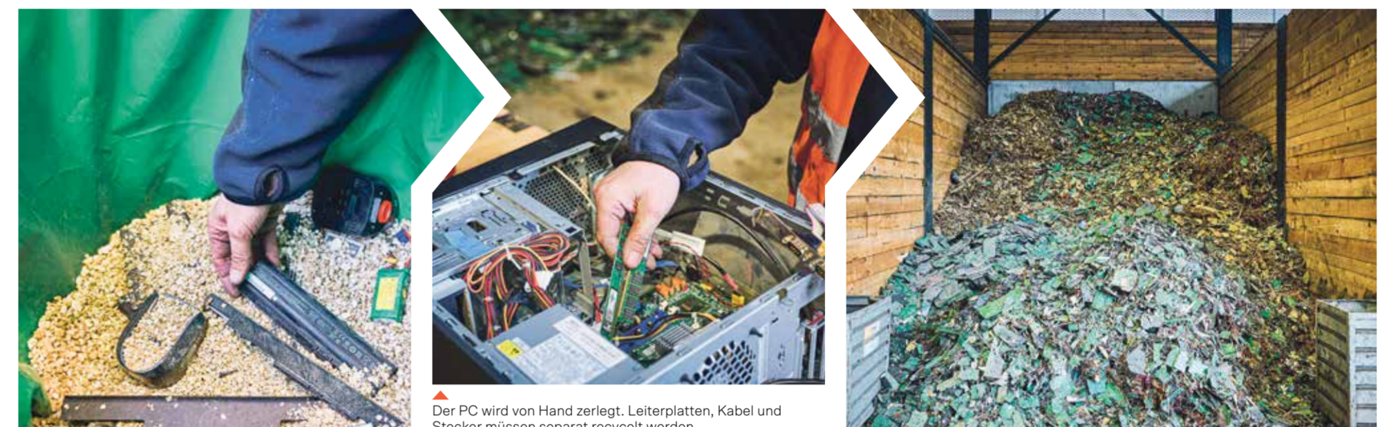
Die entflammaren Lithiumbatterien werden vor der Verarbeitung eines PCs entfernt, mit dem Brandschutzsilikat Vermiculite bedeckt und so sicher zur Batterierecyclingorganisation INOBAT transportiert.
