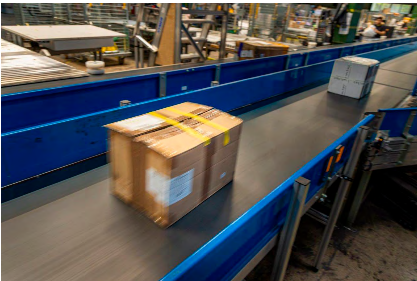
Abb. 15: Das radioaktive Testpaket mit Kaliumsalz auf dem Förderband
