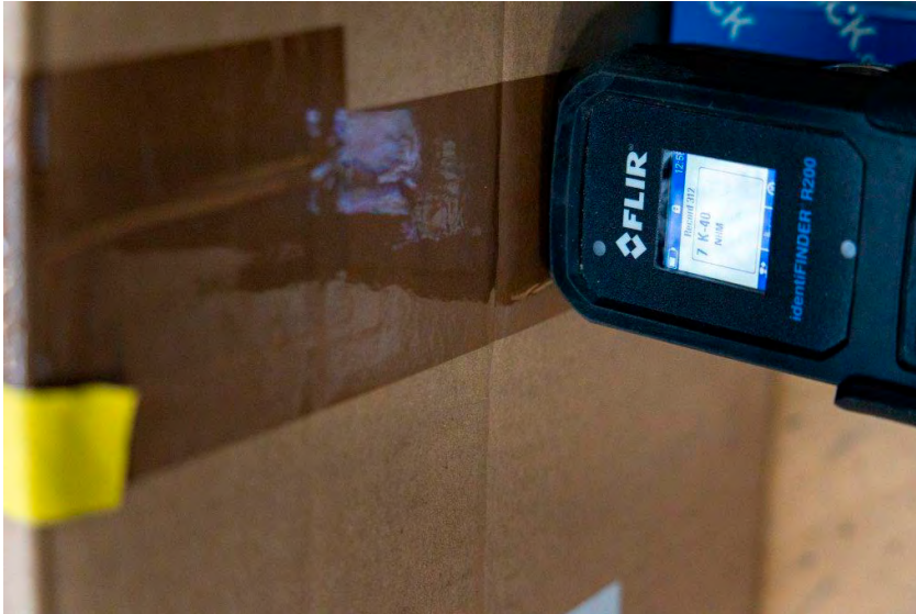
Abb. 17: Kontrolle mit Handmessgerät am Testpaket, das gemäss Messung natürliches Kalium-40 enthält
