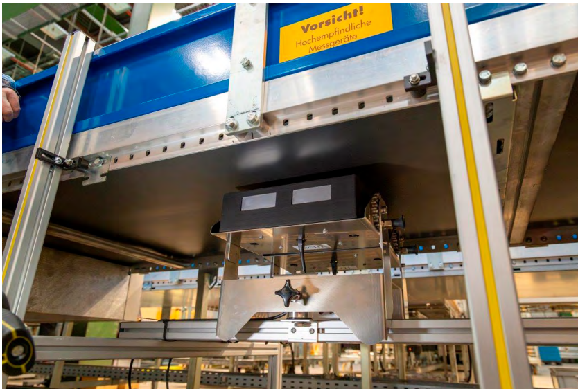
Abb. 18: An der Unterseite des Förderbandes angebrachte Szintillatoren für die Strahlungsmessung
