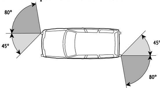
Per i veicoli delle categorie  $M_1$  e  $N_1$  gli angoli di visibilità orizzontali possono essere ridotti a  $45^\circ$  verso l'esterno, se davanti risp. dietro sono montate luci di ingombro laterali supplementari con una superficie illuminante di almeno  $12,5 \text{ cm}^2$ . Per i rimorchi l'angolo di visibilità interno deve essere pari ad almeno  $5^\circ$ .
