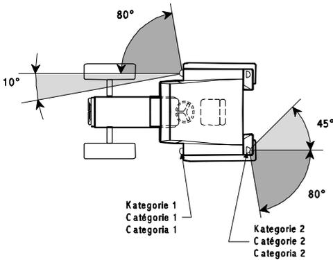
Il valore di  $10^\circ$  per la visibilità degli indicatori di direzione lampeggianti anteriori rivolti verso l'interno può essere ridotto a  $3^\circ$  per i veicoli con una larghezza non superiore ovunque a 1,40 m.
