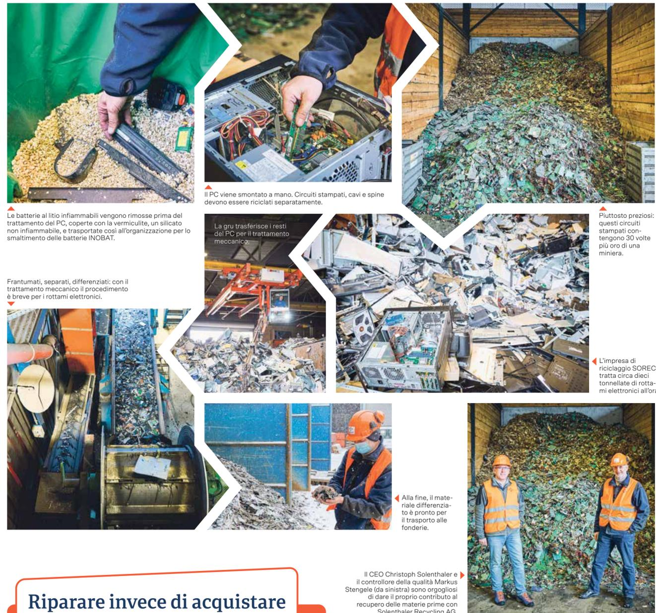
Le batterie al litio infiammabili vengono rimosse prima del trattamento del PC, coperte con la vermiculite, un silicato non infiammabile, e trasportate così all'organizzazione per lo smaltimento delle batterie INOBAT.
