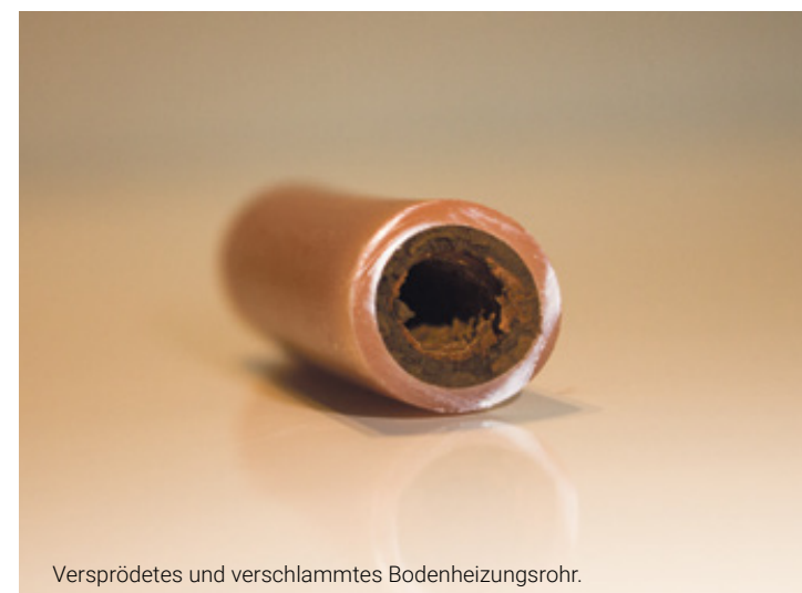
Versprödetes und verschlammtes Bodenheizungsrohr.
