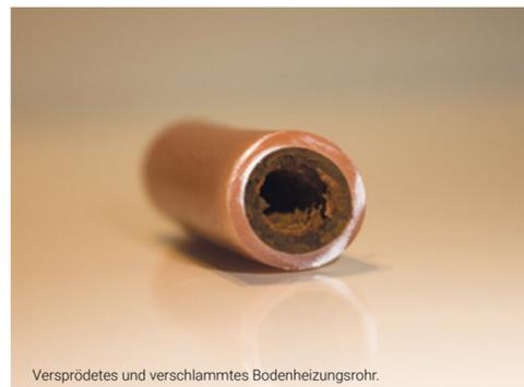
Versprödetes und verschlammtes Bodenheizungsrohr.
