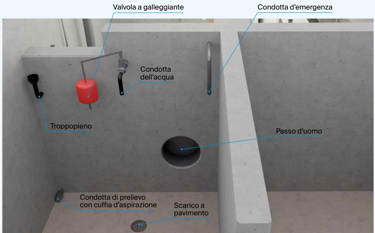
**Fig. 3** In caso d'interruzione della rete idrica locale, in cucina l'acqua potabile può essere prelevata dal serbatoio dell'acqua con una pompa manuale.
