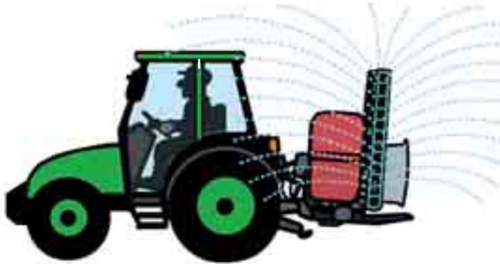
*Mesures techniques: l'épandage avec un tracteur à cabine fermée et filtre à charbon actif (cat. 4) réduit les risques dus aux produits phytosanitaires.*
