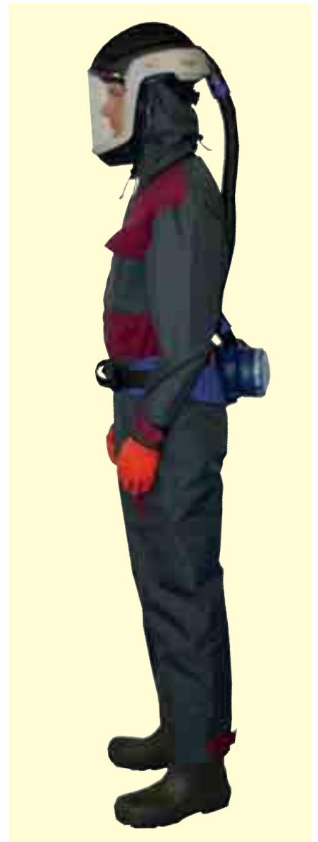
*Equipement complet de protection individuelle avec masque ventilé. Les masques à ventilation assistée sont les plus confortables pour la plupart des travaux. Un flux d'air suffisant est important. Les systèmes modernes délivrent entre 160 et 250 l/min.*
