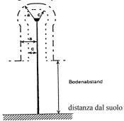
Distanze in presenza della freccia massima del conduttore o del cavo aereo in condizioni di riposo
