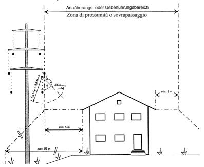
= retta per i punti di fissaggio delle catene di sospensione/amarraggio del sostegno più vicino al fabbricato
