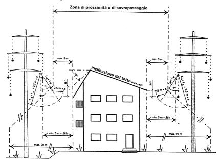
⊗ = retta per i punti di fissaggio delle catene di sospensione/amarraggio del sostegno più vicino al fabbricato
