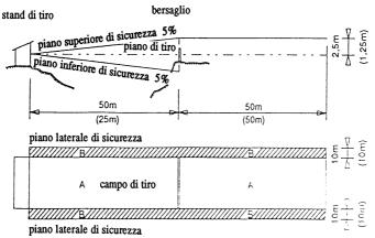
3. All'interno delle zone A e B non vi devono essere sostegni o partidi sostegni, conduttori o cavi aerei. Nella zona C sono ammessi sostegni o parti di sostegno di legno o sostegni rivestiti di legno.
