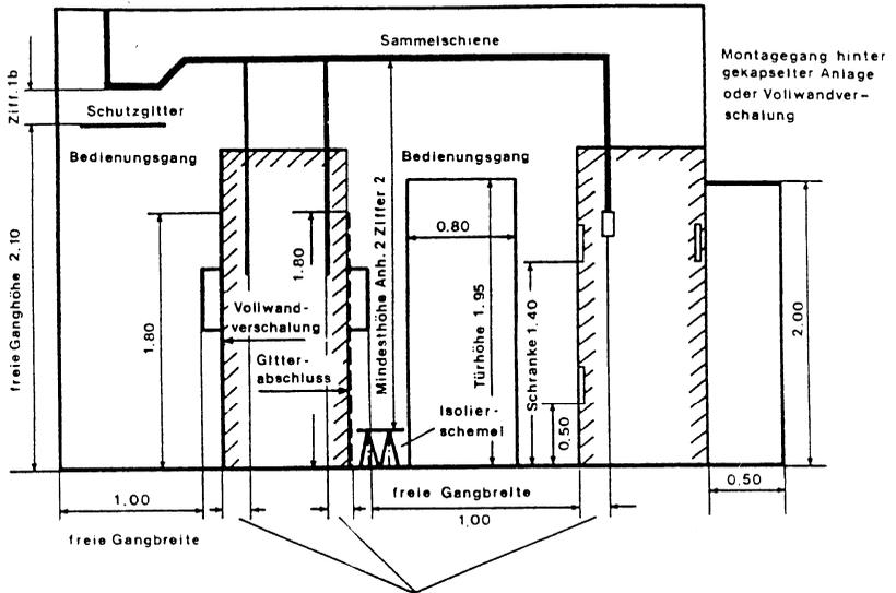
Mindestabstand zwischen unter Spannung stehenden Teilen und Schranken, Gitterabschlüssen oder Vollwandverschalungen gemäss Anh. 2 Ziffer 1
