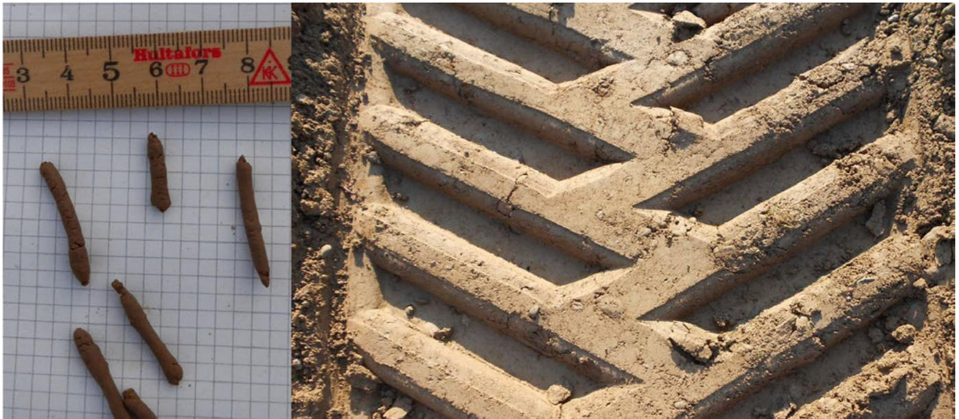
Bindiges Material und resultierende Verdichtung und Versiegelung der Oberfläche nach dem Befahren mit einer Spezialmaschine mit 700 mm Raupenbreite bei trockener Witterung.
