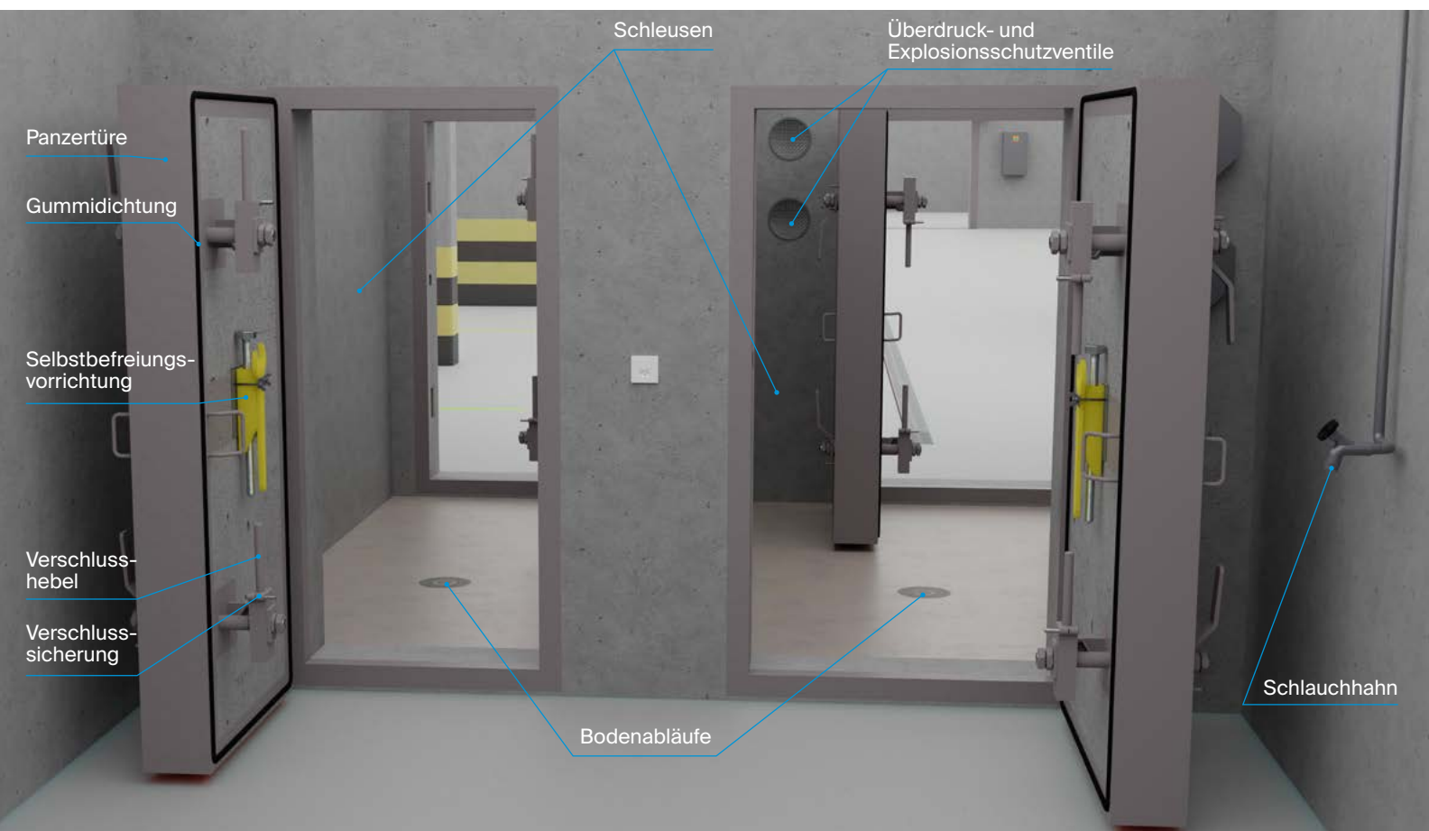
Abb. 2 Blick von der Vorreinigung in den Schutzraum. Darstellung eines Doppelseingangs mit zwei nebeneinander angeordneten Schleusen. Manche Schutzräume haben zwei Einzeleingänge.
