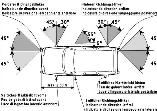
Nur für Fahrzeuge bis 6 m Länge zulässig. Distanz der seitlichen Blinker vom vorderen Fahrzeugrand höchstens 2,50 m. Die leuchtende Fläche der mitblinkenden seitlichen Markerlichter muss mindestens je 12,5 cm<sup>2</sup> betragen.
