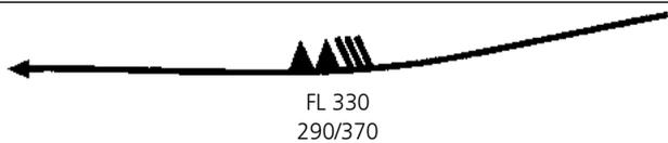
Le vent maximum est dessiné par une épaisse ligne qui donne la direction. Elle débute et finit à l'endroit où la vitesse du vent prévu est  $\geq 80$ KT. La vitesse est indiquée par les barbules, son altitude est définie par les niveaux de vol. A partir de 120KT, l'extension verticale de l'isotaque de 80KT peut être indiquée en dessus ou en dessous du corps du jet.(dans ce cas : 290/370)
