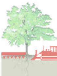
Déblai/Remblai (en cas extrême l'exécution sera faite à la main)
