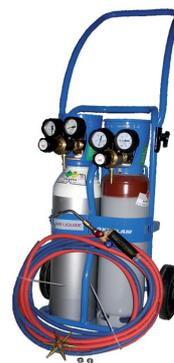
Postes de soudage oxyacétyléniques complets: Chariot de transport. Chalumeau soudeur Jetsoud SI (anti retours intégrés), avec étoile clé 6 becs n°0. Détendeurs Minidave oxygène et acétylène. 2 x 5 m de tuyau 6,3 x 12. Température de travail 3100°C.
