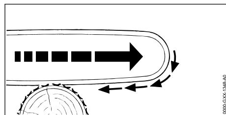
Wenn mit der Unterseite der Führungsschiene gearbeitet wird, wird die Motorsäge weg vom Benutzer gezogen.
