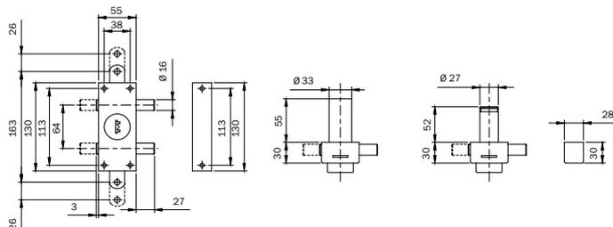
Serrure de sécurité à appliquer réversible VIS. **TROIS POINTS DE FERMETURE**. Latérale à deux pistons  $\varnothing$  16 mm, Un déplacement de 27 mm. Vertical avec haut/bas avec trou prédisposé pour accrochage barres, excursion 26 mm. **BOUSSOLE GUIDE-CLÉS INTÉRIEUR**. Deux guide-barres. Épaisseur 35 mm pour barres.
