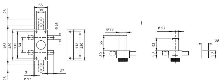
Serrure de sécurité à appliquer réversible VIS. **TROIS POINTS DE FERMETURE**. Latérale à deux pistons  $\varnothing$  16 mm, un déplacement de 27 mm. Vertical avec haut/bas avec trou prédisposé pour accrochage barres, excursion 26 mm. **BOUTON INTÉRIEUR**. Épaisseur 35 mm pour barres. Gâche à cavalier supérieur. Gâche de sol.
