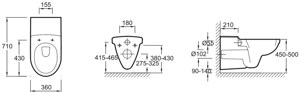
Descriptif CCTP : Cuvette suspendue longue PMR. E1195. Collection : ODÉON. DIMENSIONS : 71 x 36 cm. POIDS : 22,6 kg. MATÉRIAU : Céramique. TYPE D'INSTALLATION : Suspendu. NORMES ET RÉGLEMENTATIONS : NF. CONSOMMATION D'EAU : Standard 3/6 L. BRIDE : 1. PRODUIT INCLUS : Tube de raccord. GARANTIE DE LA CÉRAMIQUE : 10 ans. CONDITIONNEMENT : 1 colis.
