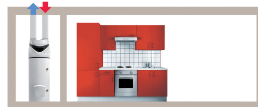
AIR EXTÉRIEUR AVEC GAINÉ POUR NE PAS REFRIGÉRER LA PIÈCE
