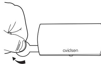
Le détecteur est prévu pour être installé sur la partie fixe d'un ouvrant (cadre d'une porte, dormant d'une fenêtre). L'aimant s'installe sur la partie mobile de l'ouvrant, à 5mm du repère sur la tranche droite du capteur.
