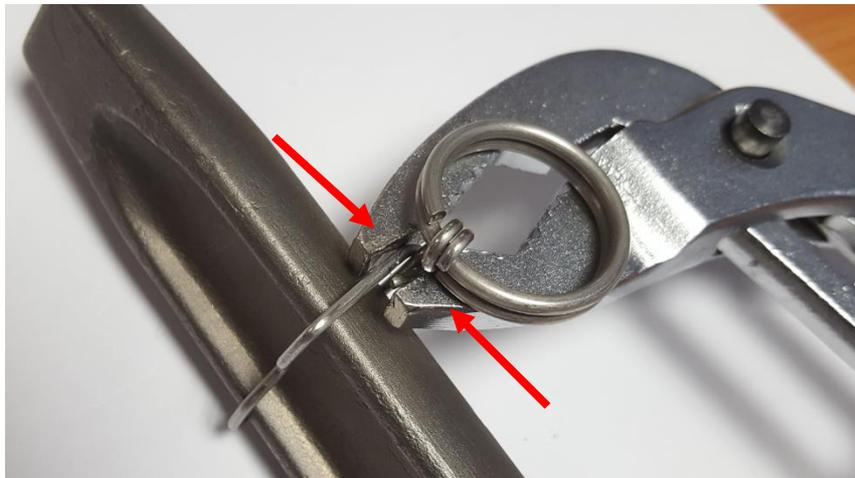
6. Lorsque les 2 parties constituant le clip sont bien assemblées et solidaires, le clip FME - qui doit être monté serré sur le corps de l'outil pour ne pas s'échapper - est alors correctement monté.
