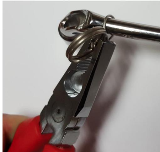
5. Avec une pince multiprise, pincer jusqu'à contact le crochet du clip FME pour le sertir afin d'éviter toute ouverture accidentelle.
