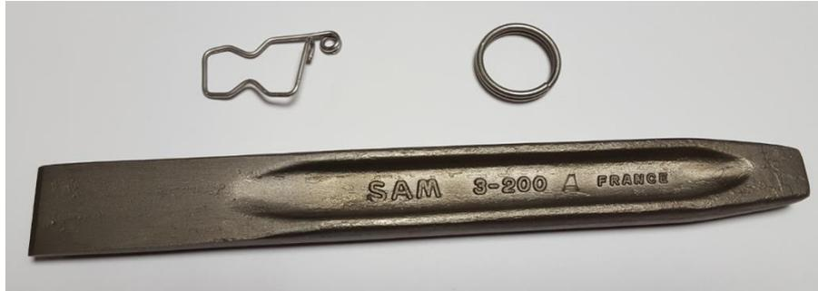
2. Utiliser le tournevis plat pour écarter une spire de l'anneau puis insérer l'anneau en le faisant tourner à 360° dans l'œil du clip FME.
