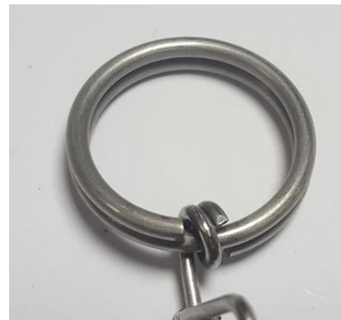
3. « Ouvrir » le clip FME en faisant levier sur la partie droite et le faire glisser autour de l'outil en veillant à positionner l'œil du clip FME sur le haut de ce dernier, au-dessus du marquage SAM.
