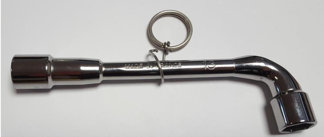
4. Verrouiller à la main le clip FME en crochétant la partie droite se terminant par l'anneau. Tirer l'anneau avec l'index et pousser le reste du clip avec le pouce.
