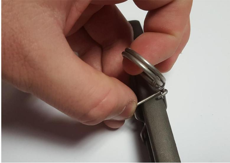
5. Avec une pince multiprise, pincer jusqu'à contact le crochet du clip FME pour le sertir afin d'éviter toute ouverture accidentelle.
