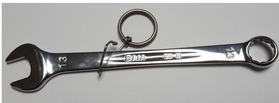
5. Verrouiller à la main le clip FME en crochétant la partie droite se terminant par l'anneau. Tirer l'anneau avec l'index et pousser le reste du clip avec le pouce.
