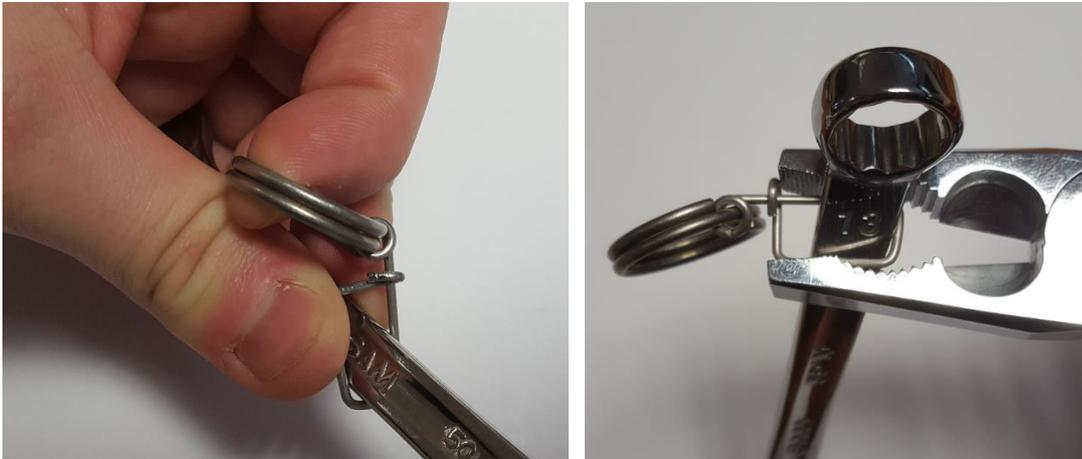
6. Avec une pince multiprise, pincer jusqu'à contact le crochet du clip FME pour le sertir afin d'éviter toute ouverture accidentelle.
