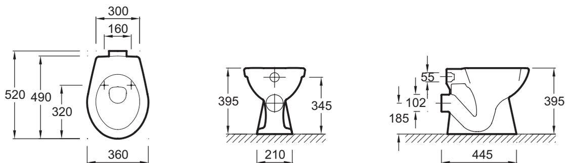
Descriptif CCTP : Cuvette indépendante, sortie horizontale. E1752. Collection : COLLECTIVITÉ. DIMENSIONS : 52 x 36 cm. POIDS : 16,4 kg. MATÉRIAU : Céramique. TYPE D'INSTALLATION : Au sol. CONSOMMATION D'EAU : Standard 3/6 L. HAUTEUR : Standard. BRIDE : 1. Sortie horizontale.
