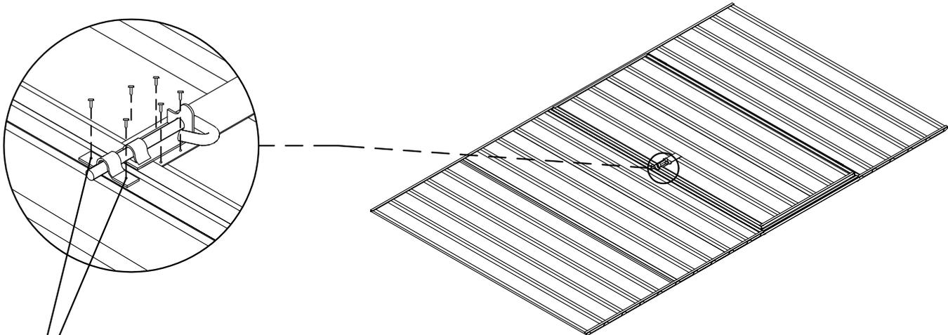
REMARQUE : les deux trous nécessaires à la fixation du morillon du loquet pour chacune des portes n'ont pas été préperforés pour que vous puissiez les aligner correctement. Placez les morillons au centre par rapport à la tige du loquet, percez des trous de 3 mm et fixez-les à l'aide de vis.
