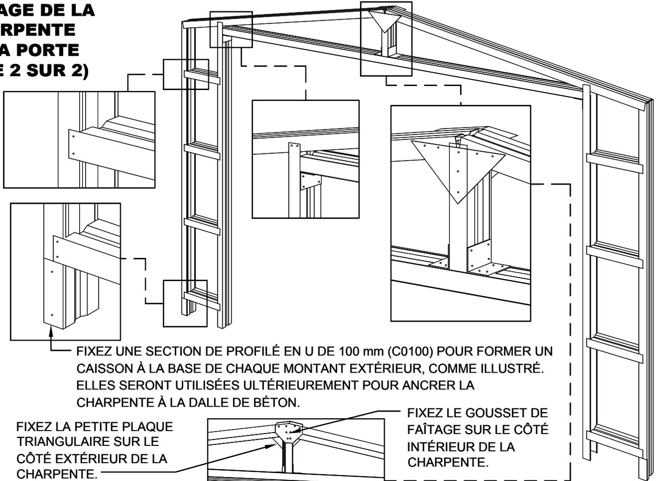
FIXEZ UNE SECTION DE PROFILÉ EN U DE 100 mm (C0100) POUR FORMER UN CAISSON À LA BASE DE CHAQUE MONTANT EXTÉRIEUR, COMME ILLUSTRÉ. ELLES SERONT UTILISÉES ULTÉRIEUREMENT POUR ANCRER LA CHARPENTE À LA DALLE DE BÉTON.
