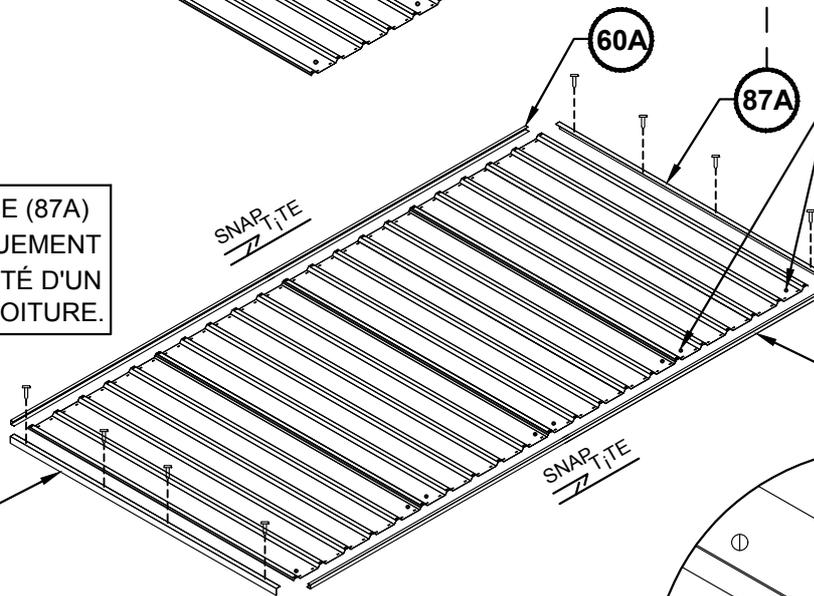
REMARQUE : LA PIÈCE (87A) SERA MONTÉE UNIQUEMENT SUR CETTE EXTRÉMITÉ D'UN DES PANNEAUX DE TOITURE.
