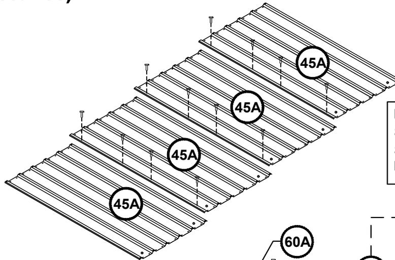
REMARQUE : LA PIÈCE (87A) SERA MONTÉE UNIQUEMENT SUR CETTE EXTRÉMITÉ D'UN DES PANNEAUX DE TOITURE.
