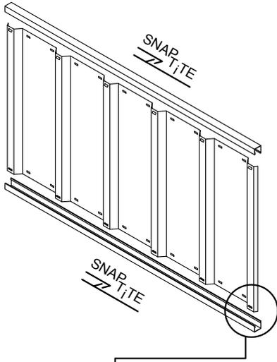
Afin de préassembler les quatre panneaux de paroi et les deux panneaux de toiture, les profilés en U s'enclenchent en haut et en bas de chacun des panneaux à l'aide du système Snap Tite, tel qu'illustré sur les pages suivantes lorsque vous verrez le symbole:
