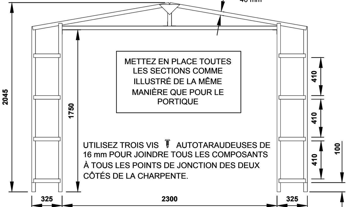
UTILISEZ TROIS VIS AUTOTARAUDEUSES DE 16 mm POUR JOINDRE TOUS LES COMPOSANTS À TOUS LES POINTS DE JONCTION DES DEUX CÔTÉS DE LA CHARPENTE.
