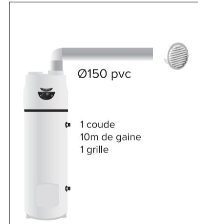
NE PAS COLLER LES RACCORDS SUR L'APPAREIL
