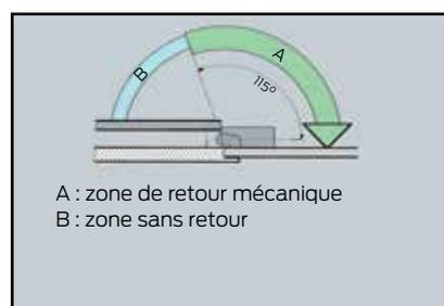
Pivots avec arrêt à 90° ou à 105°.
