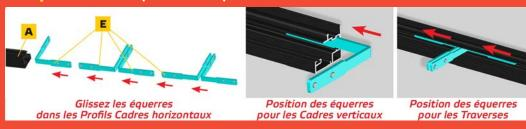
**Etape 4:** Montage des Profils Cadre verticaux
