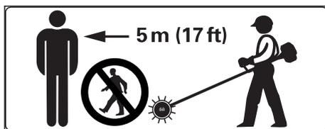
À part l'utilisateur, personne ne doit se trouver dans un rayon de 5 m de la machine en marche – **risque de blessure par des objets projetés !** Respecter aussi cette distance par rapport à des véhicules, des vitres etc. – **risque de dégâts matériels !**
