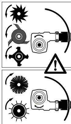
Pour les outils de balayage et de nettoyage, positionner le réducteur de telle sorte que l'arbre d'entraînement de l'outil se trouve en haut, par rapport au tube.
