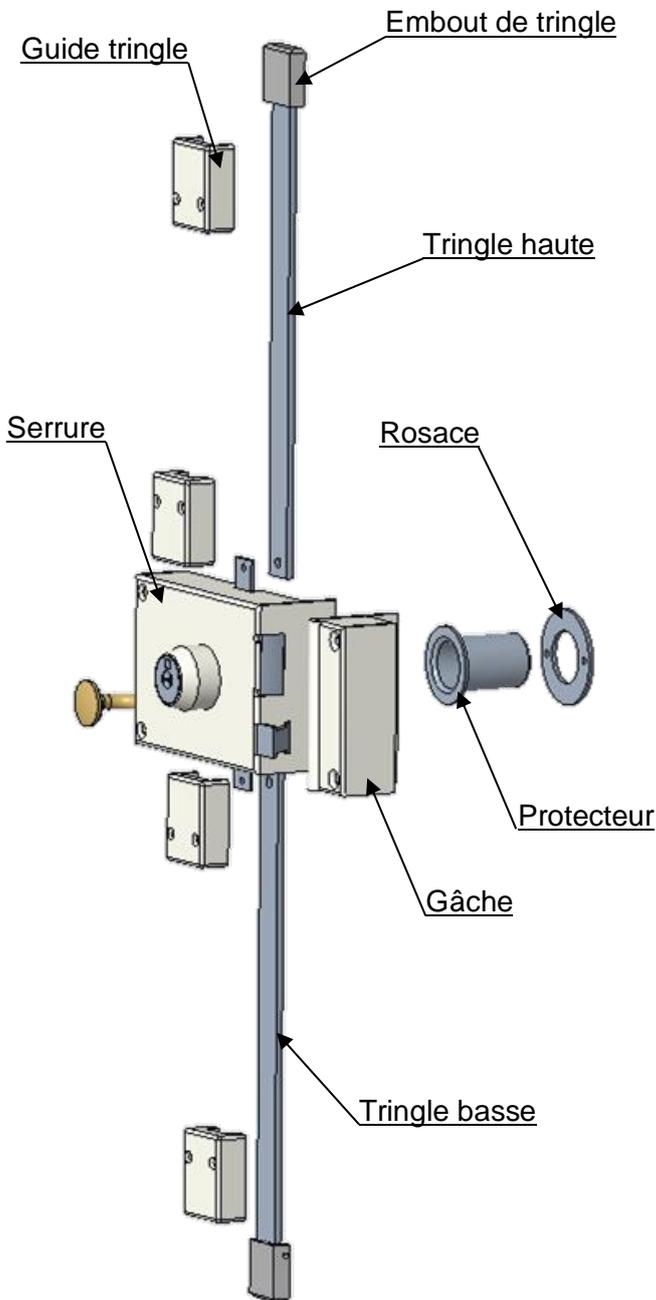
1 – Percer un trou de  $\varnothing$  32 mm minimum dans la porte à environ 985 mm par rapport au sol et à 60 mm du bord de la porte.
