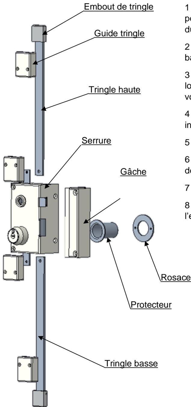
1 – Percer un trou de  $\varnothing$  32 mm minimum dans la porte à environ 985 mm par rapport au sol et à 50 mm du bord de la porte.
