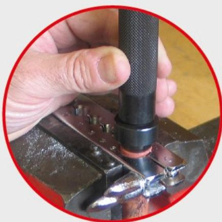
Permet d'évaser les extrémités des tubes de cuivre. A utiliser avec une matrice à collets «à frapper» 185445 ou 180440 et un marteau à garnir. Poignée anti dérapante.
