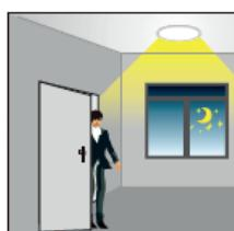
Lorsqu'un mouvement est détecté, le luminaire éclaire à 100% de luminosité.
