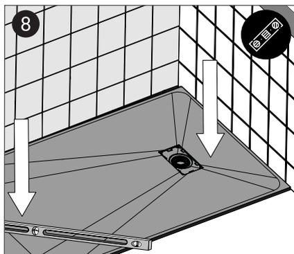
8 Fixez le siphon sur le receveur à l'aide de la bague de serrage de la bonde, voir les instructions séparées pour les bonde. Appliquer une bâche de protection sur l'ensemble de la zone de douche.
