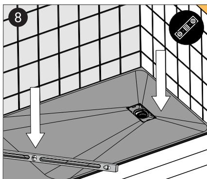
8 Fixez le siphon sur le receveur avec la bague de serrage de la bonde, voir les instructions séparées pour la bonde. Appliquez une bâche protectrice imperméable sur l'ensemble de la zone de douche.
