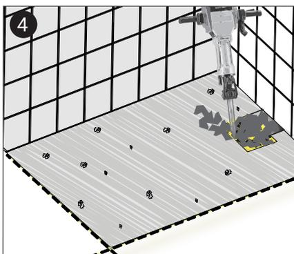
4 Pour une installation au sol, retirer le matériau du sol pour la zone de la bonde et un canal pour le tuyau d'évacuation.
