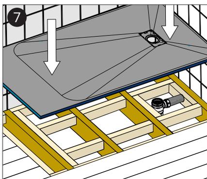
7 Appliquez de la colle sur tous les points de contact entre le receveur, les solives et les renforts. Placez le receveur au dessus de la bonde et fixez-le en position après avoir bien vérifié les niveaux.
