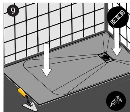
9 Les revêtements de sol ou le carrelage doivent affleurer jusqu'aux bords du receveur et être scellés avec du silicone. Protégez le siphon et le couvercle des débris pendant l'installation.
