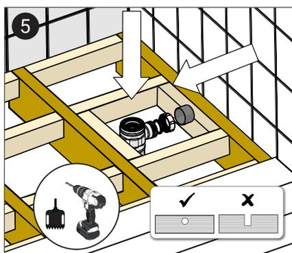
5 Installez le siphon et le tuyau d'évacuation de la bonde. Ne pas couper dans les solives, toujours percer lors du raccordement au tuyau d'évacuation de la bonde.
