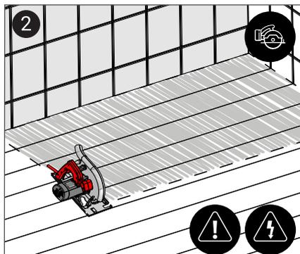
2 Pour une installation encastrée, couper dans le plancher, en prenant soin de ne pas couper à travers les solives de support ou tout câblage de plomberie ou électrique.
