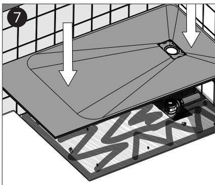
7 Posez le receveur et vérifiez la hauteur par rapport à la hauteur du sol fini. Fixez fermement le receveur en position et vérifiez que les 4 côtés sont à nouveau de niveau.
