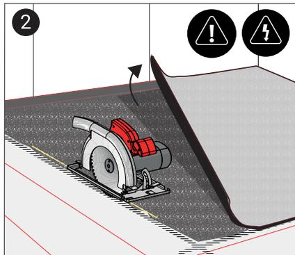
2 Pour une installation encastrée, couper dans le revêtement de sol en prenant soin de ne pas couper à travers les matériaux de support, la plomberie ou le câblage électrique.
