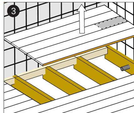
3 Retirez soigneusement les planches de plancher et localisez le tuyau d'évacuation de la bonde. Pour une installation au sol, retirez les planches de plancher autour de la zone de la bonde.
