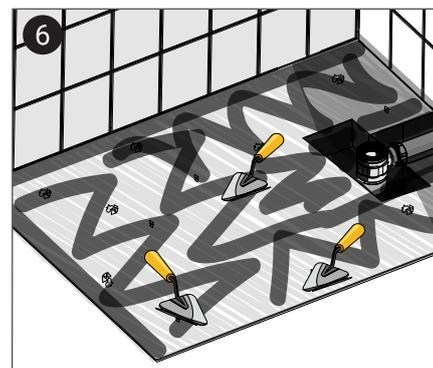
6 Retirez tous les débris et assurez-vous qu'il n'y ait pas de débris. Mettre à niveau et à la bonne hauteur toute la surface du receveur à l'aide d'un mélange type "Chape maigre", colle polyuréthane et ou réagrégé.
