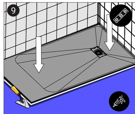
9 Les revêtements de sol ou les carreaux doivent affleurer jusqu'aux bords du receveur et être scellés avec un silicone. Protégez le siphon et le couvercle de la bonde pendant l'installation.
