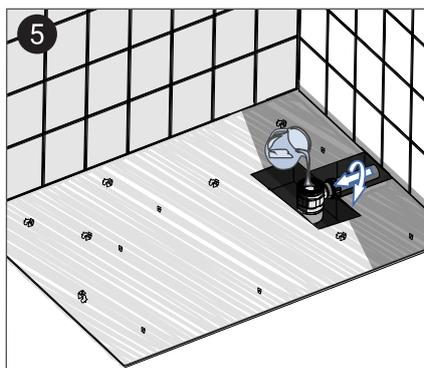
5 Installez le siphon et le tuyau d'évacuation de la bonde. Testez le avec une mise en eau pour vérifier l'écoulement. Assurez-vous que le joint en caoutchouc est en place sur le dessus de la bonde. Vérifiez la position de l'évacuation de la bonde avec le bac.
