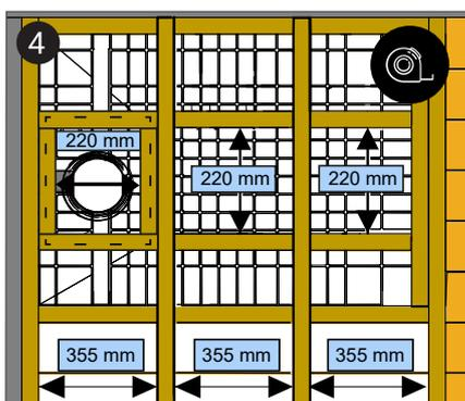
4 La bonde doit être soutenue par des renforts supplémentaires, 220 mm autour de la bonde. Des solives ou tout autres renforts peuvent être utilisés sur les bords du receveur. Nous conseillons de les espacer de 355mm au minimum.
