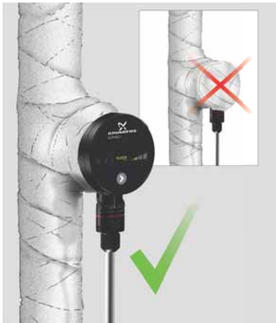
Fig. 4 Isolation du corps du circulateur
