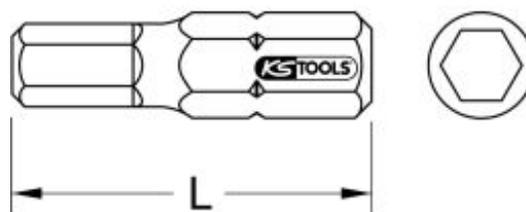
**EMBOUT POUR TOURNEVIS À FRAPPER 6 PANS, 7 MM**
