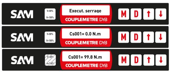
Au relâchement de (M) pour valider la programmation, le message « Execut. Serrage » apparaît pendant 1 seconde, puis la mémoire se positionne à « Cs 001 = 0.0N.m » indiquant que l'on peut réaliser e couple de serrage (Cs) n° 001 et que la remise à zéro automatique est bien réalisée.
