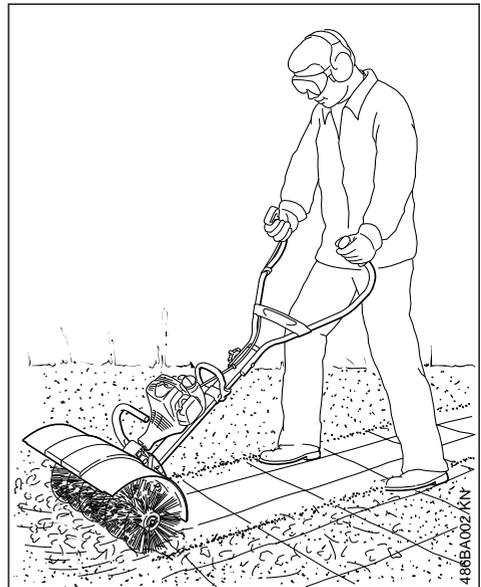
Das MultiWerkzeug Kehrbürste KB-MM dient zum Reinigen von Flächen und Wegen, auch bei unebenen oder verfugten Flächen sowie Natursteinböden.
