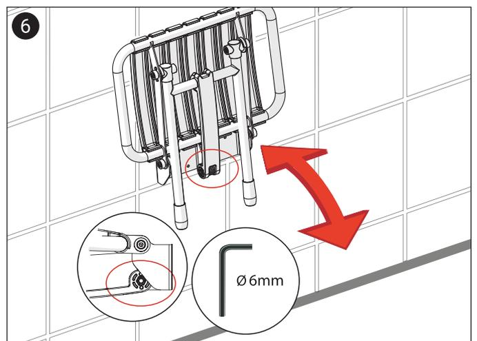
Pour régler le degré d'abaissement du siège, serrez ou desserrez le boulon de liaison sous le siège à l'aide d'une clé Allen de 6 mm.
