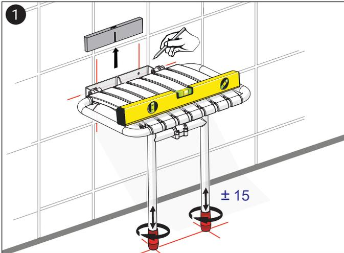
Déterminez la hauteur d'utilisation du siège et mesurez cette hauteur contre le mur. Vérifiez la présence d'obstacles ou de tuyauteries avant tout perçage ou fixation.
