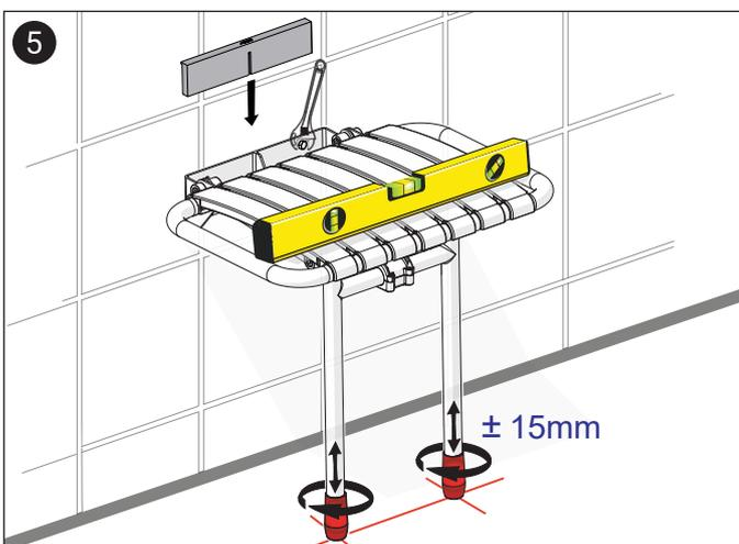
Ne serrez pas trop les fixations. Vérifiez le fonctionnement du siège, les niveaux et le positionnement des pieds lorsqu'il est relevé et abaissé.
