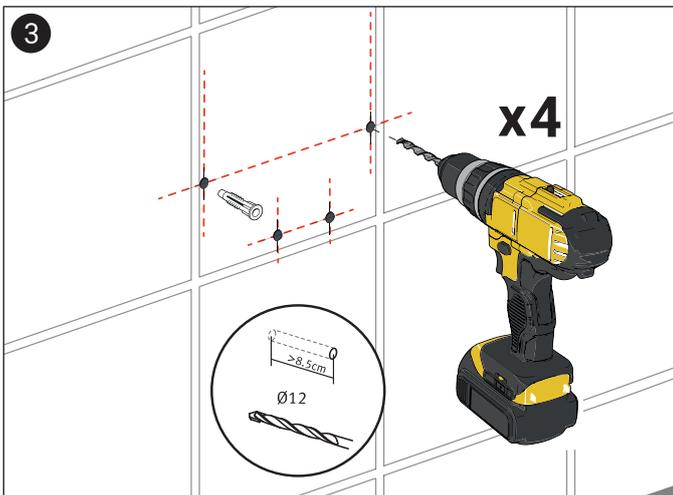
Vérifiez les câbles et la tuyauterie. Utilisez un morceau de ruban adhésif pour marquer le mur carrelé et pour protéger le carrelage des éclats. Percez les trous avec une pièce de forage pour mur / carrelage appropriée. Fixations non fournies.
