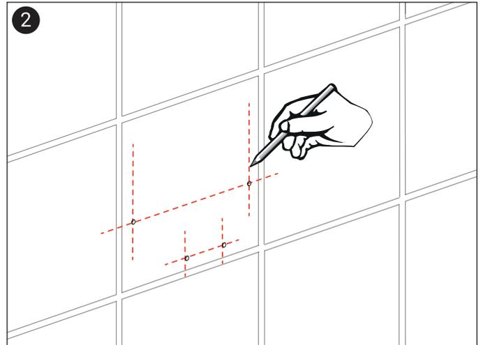
Marquez la position des trous de la platine de fixation sur le mur en vous assurant que le siège est de niveau. Ajustez les pieds pour effectuer un réglage plus fin.
