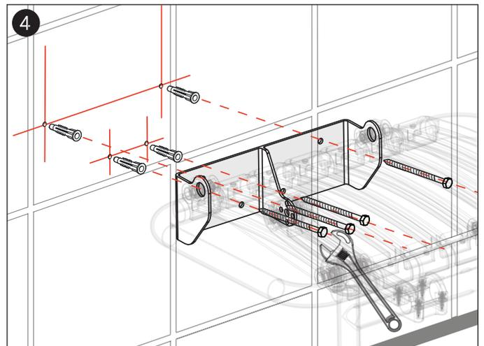
Utilisez des fixations murales appropriées pour fixer le support de montage au mur. N'utilisez pas de vis à tête fraisée car cela peut réduire la résistance du siège et invalidera toute garantie ou charge maximale indiquée.
