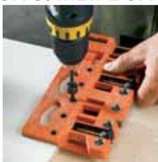
Pour le pointage et perçage des attaches façade, tubes, dos et fonds de tiroir. adapté pour TANDEMBOX et METABOX.
