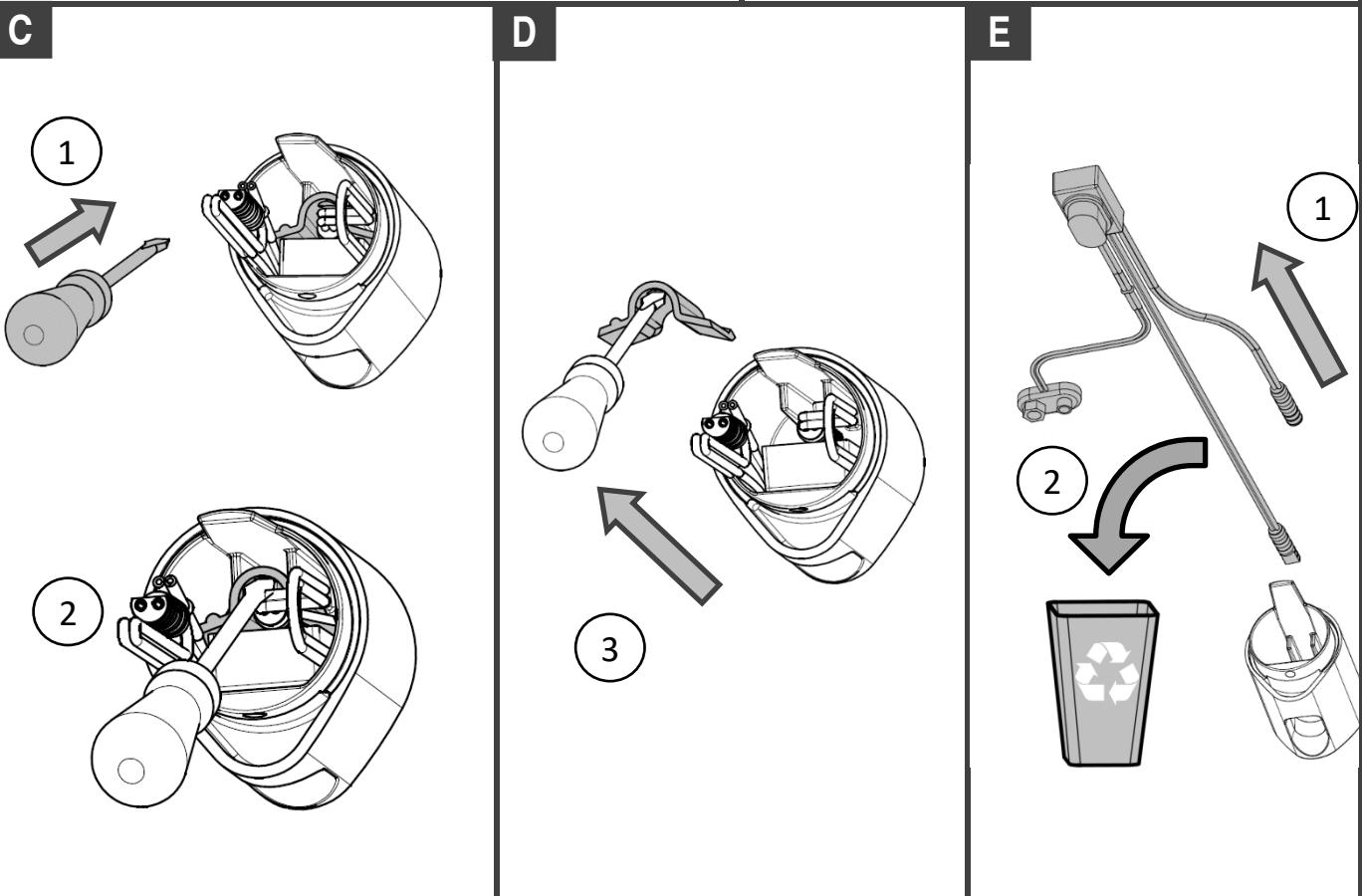
**7-4 Maintenance de l'aérateur / Maintenance of the flow aerator / Wartung Perlator / Mantenimiento del aireador / Manutenzione dell'areatore / Onderhoud beluchter**
