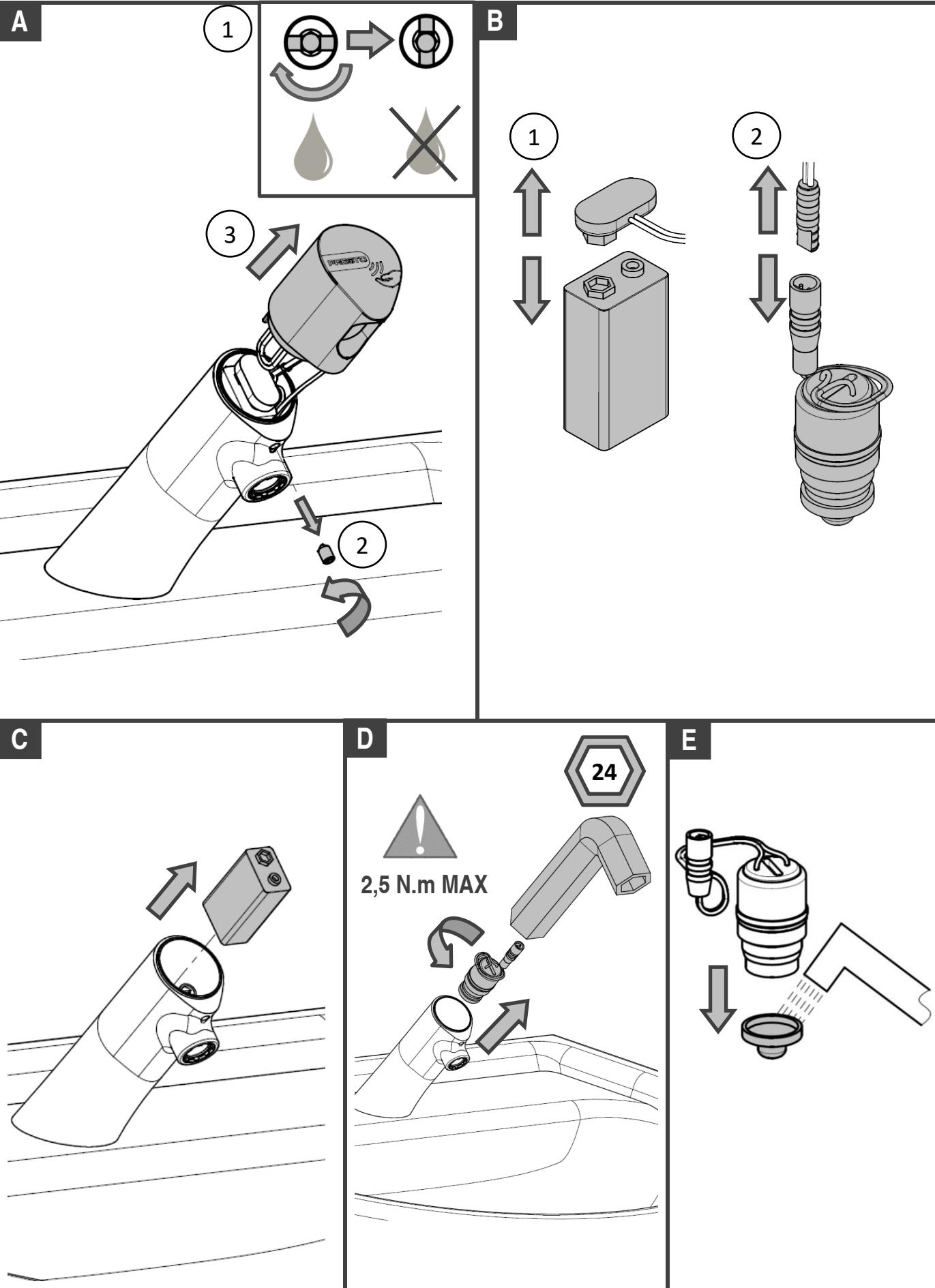
**7-3 Remplacement cellule / Replacing the cell / Auswechseln des Sensors / Sustitución de la célula /
