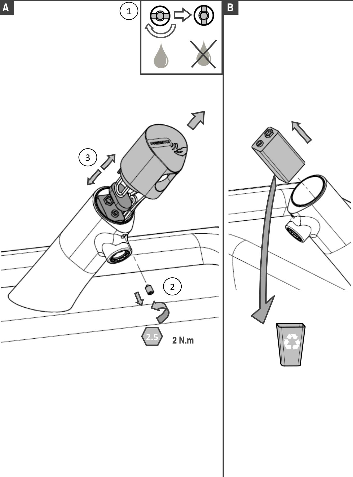
**7-2 Remplacement/ Nettoyage du filtre et électrovanne / Replacing/ Cleaning the filter and the solenoid valve / Filterreinigung / Auswechseln des Magnetventils / Sustitución / Limpieza del filtro y de la electroválvula / Sostituzione / Pulire il filtro e l'elettrovalvola / Vervanging/Reiniging van filter en magneetventiel**
