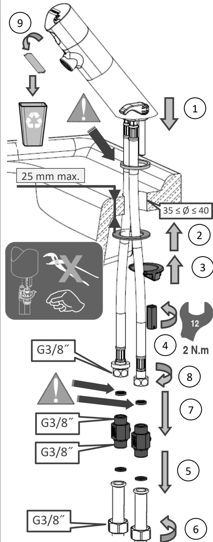
**3-2 Version Simple sur plage / Single deck-mounted tap / Standventil / Grifo sobre repisa / Rubinetto bordo lavabo / Wastafelkraan voor bladmontage**
