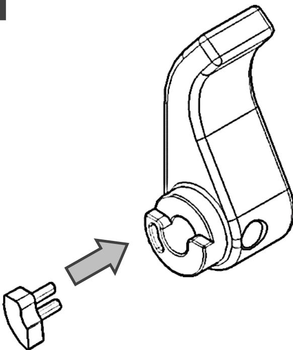
**Butée de limitation de température à 40° : pour obtenir de l'eau à 40°C en position tout «chaud», régler la butée comme indiquée ci-dessus, en fonction de la température de l'eau chaude du réseau (TR) à pression équilibrées et débit réglé en sortie >3L/min.**
