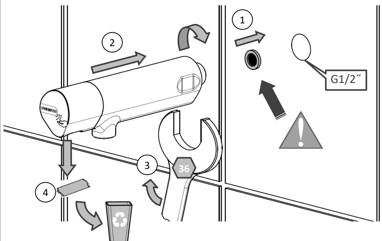
3-4 BIS Version Simple mural / Single wall-mounted tap / Wand-Auslaufventil / Grifo sobre muro / Rubinetto murale / Tapkraan voor wandmontage
