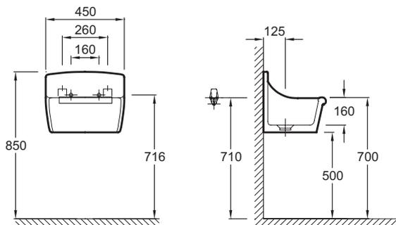
Descriptif CCTP : Vidoir mural. E1898. Collection : NORMA. DIMENSIONS : 45 x 35 cm. POIDS : 14,2 kg. MATÉRIAU : Céramique. FIXATIONS : Attaches fonte en option E4598. Version non percée.
