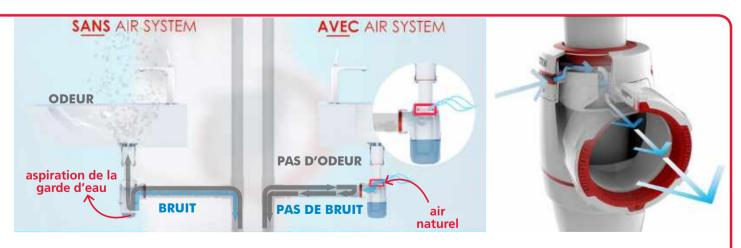
Quand une dépression est créée dans les tuyaux, cela aspire l'air mais aussi l'eau contenu dans le siphon (la garde d'eau). **WIRQUIN NEO AIR** permet aux canalisations d'être naturellement ventilées : quand une dépression est créée dans les tuyaux, la membrane de **WIRQUIN NEO AIR** s'ouvre, crée la ventilation et empêcher ainsi l'aspiration de la garde d'eau.
