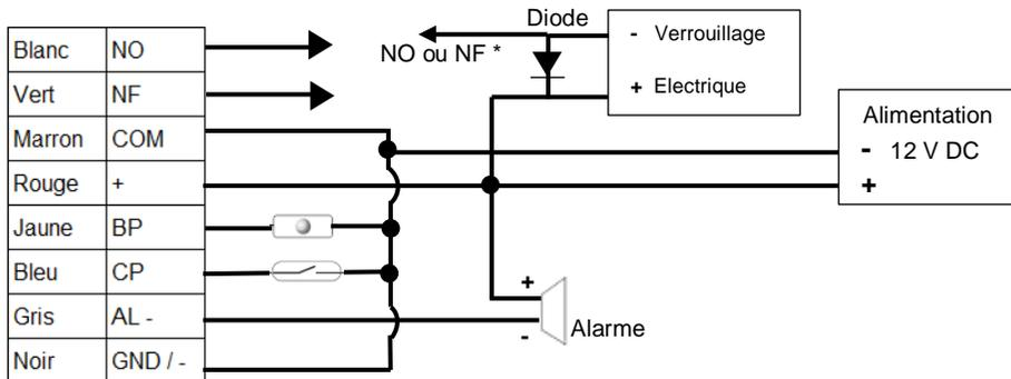
\* Pour un verrouillage électrique à émission, connectez le pôle négatif du verrouillage à NO. Pour un verrouillage électrique à rupture, connectez le pôle négatif du verrouillage à NF.
