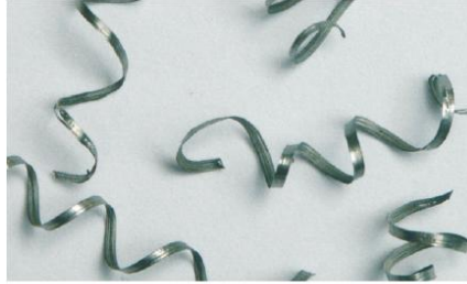
L'enroulement modéré des copeaux indique des conditions de coupe correctes.
