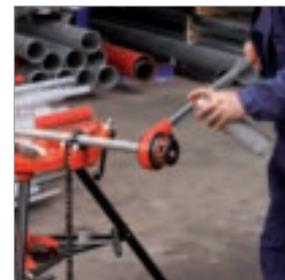
*Avec le levier à cliquet 1/4 - 2", le logement des cages à filière se fait par un adaptateur de 1/4 - 1.1/4" (No. 600011500)*
