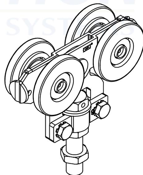
Monture fixation sur chant, 4 galets acier montés sur billes.
