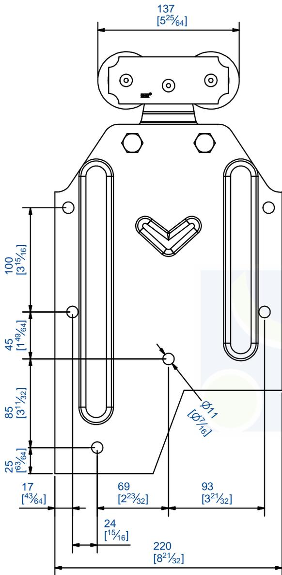
Montre fixation sur plat, 2 galets acier sur cages à rouleaux.
