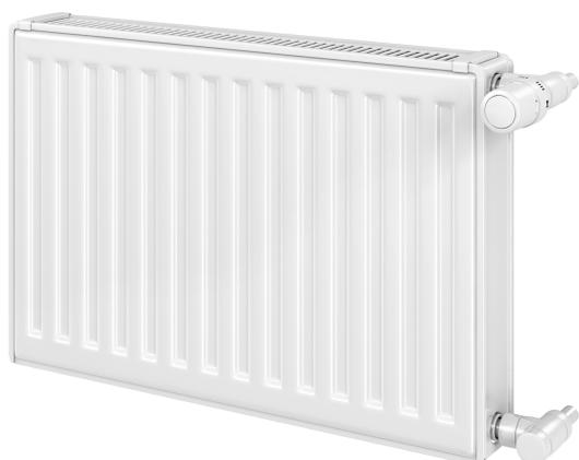
L'emblématique radiateur panneaux acier Reggane 3000 Compact évolue et devient Reggane 3010 Compact. Nouveauté : Sa pression de service de 10 bar ainsi que son pas de 40 mm (canal d'eau) vous apporte plus de performance thermique ! Compatible avec tous les systèmes de chauffage central, ce radiateur eau chaude disponible en 6 hauteurs et en largeur de 400 à 3000 mm. Raccordement : 4 orifices en bout Ø 15/21. Couleur standard : RAL 9016 Blanc Traffic - en option : 63 couleurs.
