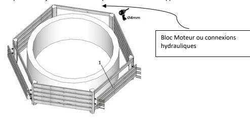
7 / Installez les 6 margelles #3 sur la structure DecorSpa, assurez-vous qu'elles soient parfaitement ajustées aux poteaux, et les unes aux autres, avec un débord de 10mm par rapport aux planches du mur
