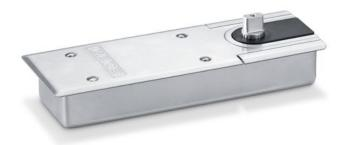
Pivot de sol pour portes battantes à simple action ou portes à double action à un vantail avec une largeur de vantail jusqu'à 1100 mm avec force de fermeture réglable EN 1-4 et fonction maintien porte ouverte en option
