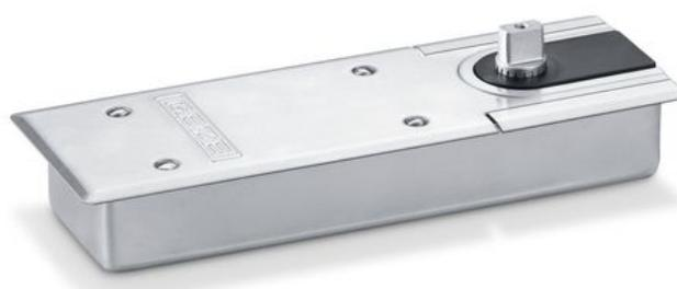
Pivot de sol pour portes battantes à simple action ou portes à double action à un vantail avec une largeur de vantail jusqu'à 1100 mm avec force de fermeture réglable EN 1-4 et fonction maintien porte ouverte en option
