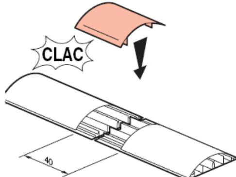
Montage avec passage de plancher 92x20mm
