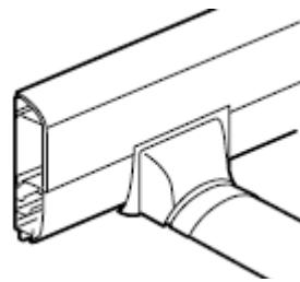
Permet la dérivation d'une plinthe 140x35 mm vers un passage de plancher réf. 0 328 00
